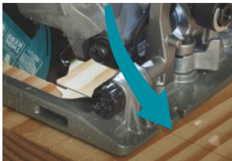
Wydmuch wiórów z linii cięcia & dioda LED
