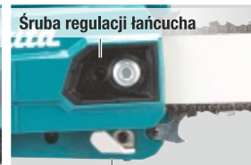
Śruba regulacji łańcucha Wymiana i naciąg łańcucha przy pomocy narzędzia
