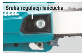
Sruba regulacji łańcucha Wymiana i naciąg łańcucha przy pomocy narzędzia
