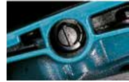
Metalowa pompka olejowa z możliwością regulacji. Zapewnia doskonale smarowanie łańcucha zatrzymując się w momencie pracy urządzenia na biegu jał.
